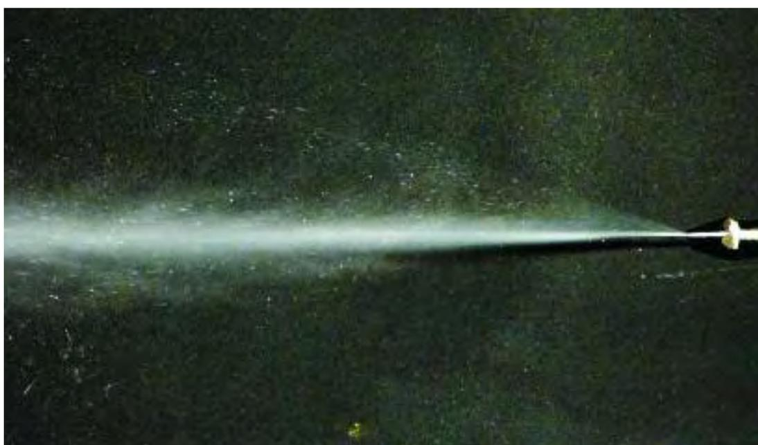
Рисунок 1.6 – Факел распыла струйной форсунки
