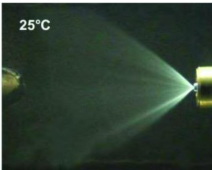
Рисунок 1.5 – Факел распыла центробежной форсунки
