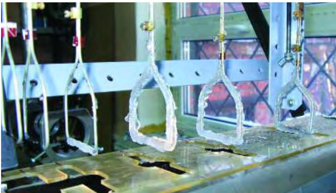
Рисунок 1.11 – Прогрессирующее намерзание льда на термопарных зондах вдоль по потоку воздуха.
